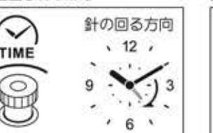
※ツマミは必ず指定の矢印の方向へ回して下さい。
