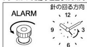
※ツマミは必ず指定の矢印の方向へ回して下さい。
