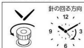
※ツマミは必ず指定の矢印の方向へ回して下さい。
