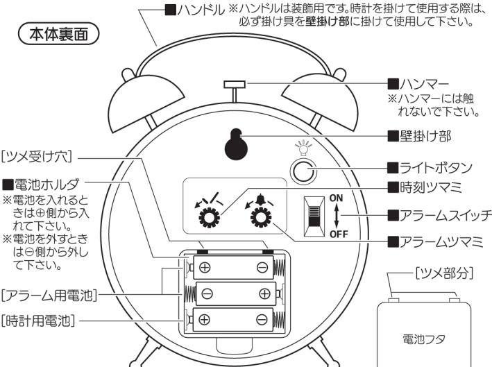
△注意 種類の違う電池、古い電池と新しい電池などを混ぜて使用しないで下さい。電池の破裂や時計の故障の原因になります。
