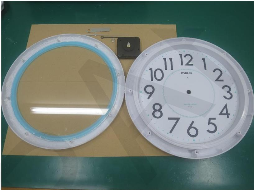
写真5 粉じん試験後の試験品内部
