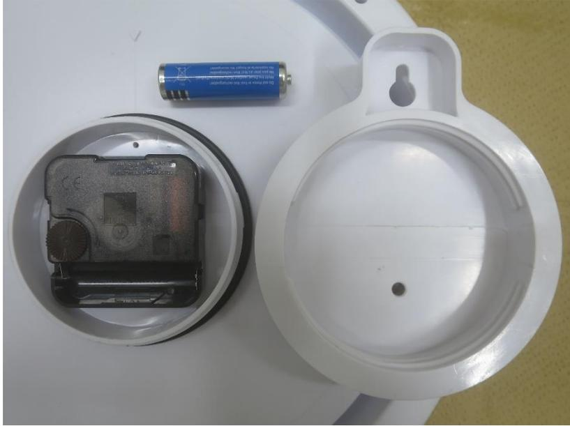
写真4 粉じん試験後の試験品内部
